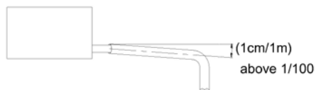
Figure 6.1 Pente minimale de la tuyauterie d'évacuation
