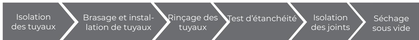
Remarque : le rinçage des tuyaux doit être effectué une fois que les raccords brasés sont terminés, à l'exception des raccordements finaux aux unités intérieures. En d'autres termes, le rinçage doit être effectué une fois que l'unité extérieure a été raccordée, mais avant que les unités intérieures ne soient raccordées.
