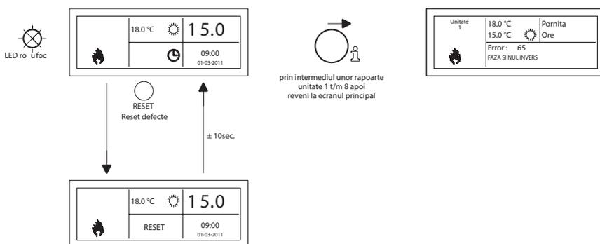
Cu ajutorul butonul Resetare, Defecțiunea poate fi rectificată după ce Mesajul va dispărea, iar pe afișaj va apărea din nou ecranul principal.
