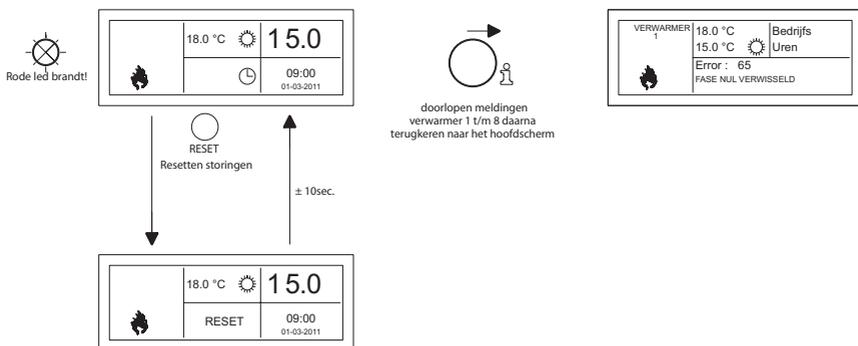
Met de drukknop Reset kan de storing worden ontgrendeld waarna melding zal verdwijnen en het hoofdscherm weer op het display verschijnt.
