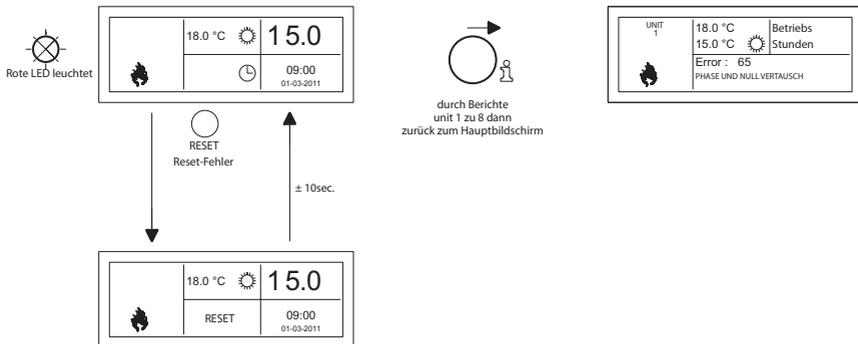
Mit der Reset-Taste kann die Störung entspert werden, woraufhin die Meldung verschwindet und der Hauptbildschirm wieder auf dem Display erscheint.
