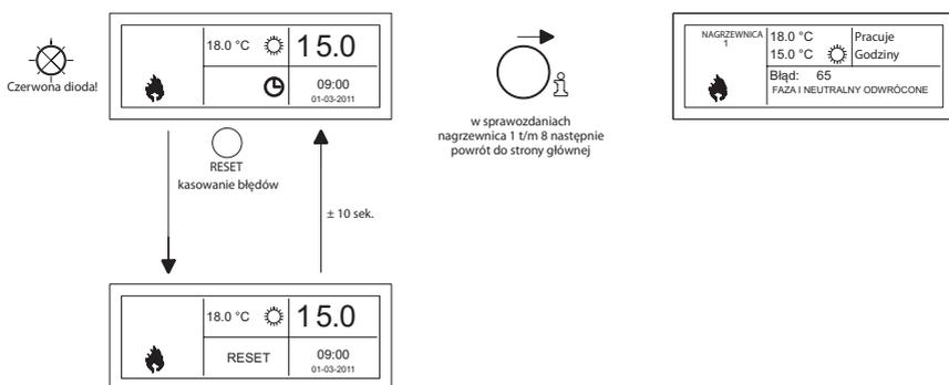
Awarię można odblokować przy użyciu przycisku Reset. Powoduje to zniknięcie komunikatu i wyświetlenie ekranu głównego na wyświetlaczu.
