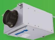
L'unité de désinfection de l'air frais Mark (MDU) peut être utilisée en combinaison avec une Mark ERV. Le MDU est équipé d'une lampe germicide à UV-C d'une longueur d'onde de 254 nm et un filtre médical de stérilisation photocatalytique permettant de tuer rapidement les bactéries et les virus.
